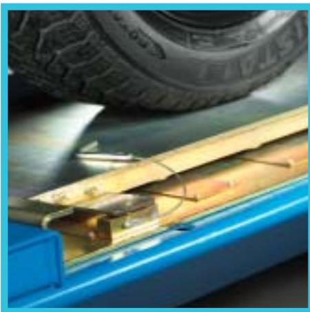
Der Schiebeuntersatz Langversion (Best.-Nr. 932 401 011) für die Ausfederung der Hinterräder hat zusätzlich noch einen Drehbereich von  $\pm 2,5^\circ$  bis  $\pm 10^\circ$ .
