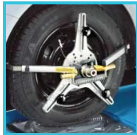
Die Multiquick-Spanneinheit (Best.-Nr. 932 401 111) garantiert eine schnelle Befestigung der Messwertaufnehmer am Rad. Spannbereich bis 23"-Felgendurchmesser (optional bis 26").
