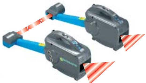
Die neuen CCD-Kameras mit erweitertem Spurmessbereich und integriertem Sturzpindel ermöglichen die Nachlaufmessung bei 20° mit mechanischen Drehuntersätzen bei einer Messdistanz von 6 m (18 m optional).
