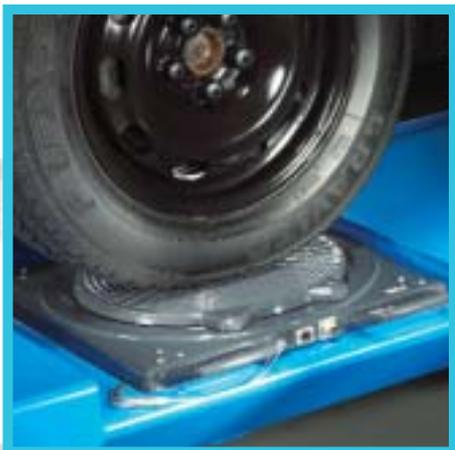
Der Alu-Drehuntersatz (Best.-Nr. 932 501 210) sorgt mit seiner extremen Beweglichkeit für verspannungsfreie Vorderräder bei den Einschlagsmessungen.
